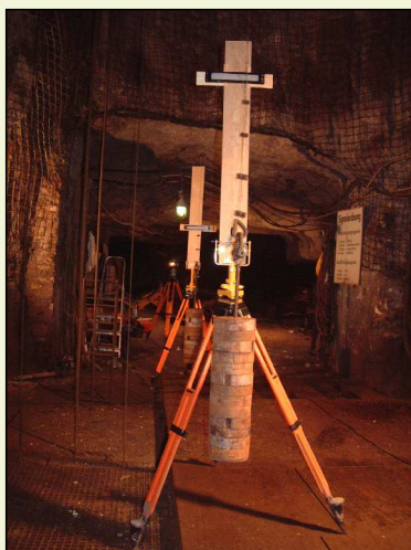
Kreisel Gi-B 3 (MOM) im untertägigen Einsatz
